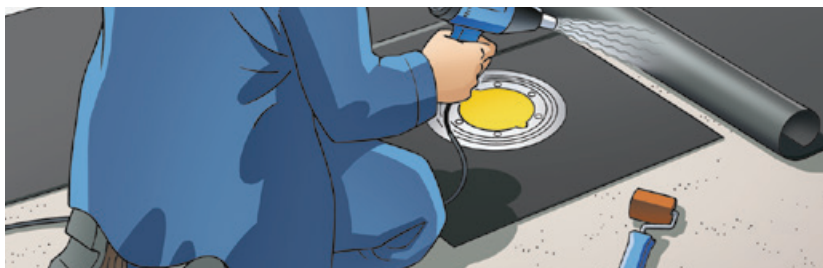
Ilustr. 3 – 21 Zgrzanie membrany EPDM opalarką
